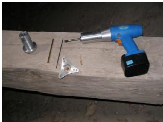
Obrázek 8.: Sada vybavení pro odběr radiálního vývrtnu [1]
