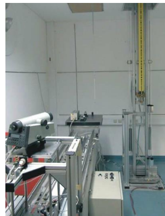
Obrázok 6.: Vertikálny komparátor na TU Graz (Woschitz et al., 2003)
