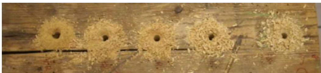
Obrázek 10.: Piliny vyvrtané ze dřevěného prvku [3]
