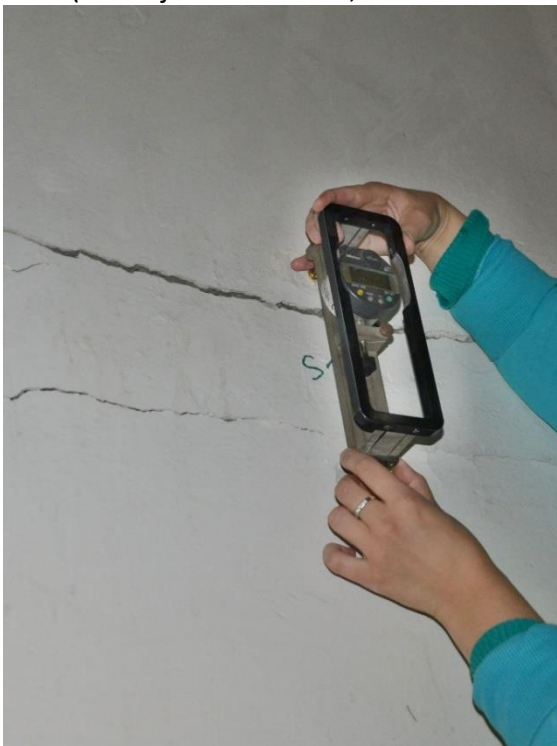
Obr. 2 Hollanův přiložený deformetr při měření vodorovné spáry na jednoduché základně
