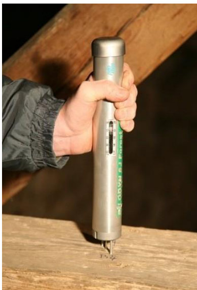
Obrázek 3.: Příklad přístroje Pilodyn 6J používaný při měření [1]
