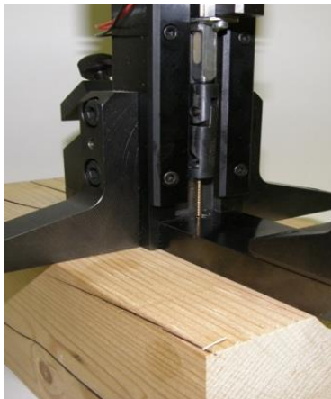
Obrázek 7.: Přístroj pro vytahování vrutu [2]
