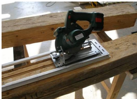
Obrázek 9.: Okružní pila s vodícím trámem pod úhlem 45°[1]
