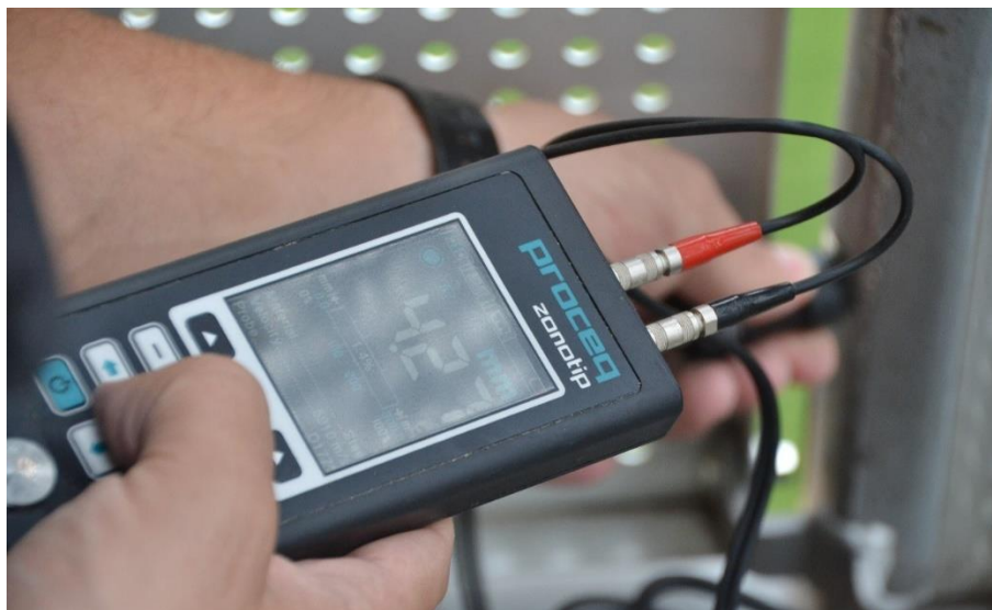
Obrázek 4.: Ultrazvukový tloušťkoměr Zonotip pro stanovení tloušťky stěny profilu
