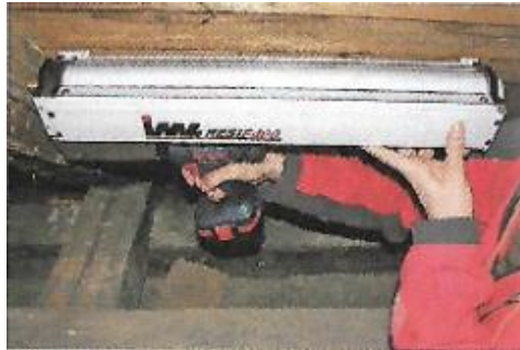
Obrázek 4.: Příklad pro odporové mikrovrtní – RESIF 400 [1]
