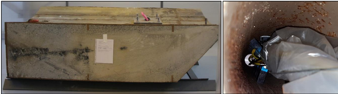
Obrázek 9.: Měření betonu biologického stínění pomocí prototypu manipulátoru „Horymír“ (vlevo: pohled na zkoumaný blok betonu, vpravo: manipulátor Horymír nesoucí měřící sondy v ionizačním kanálu zkoumaného betonového bloku)
