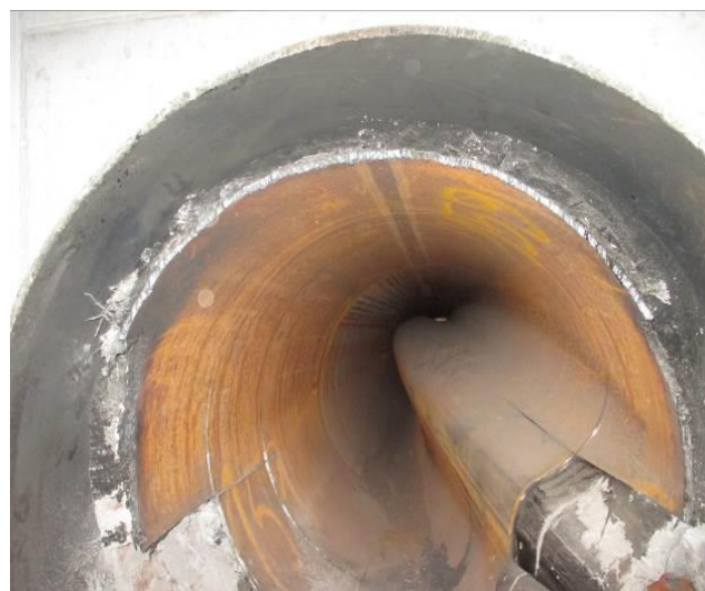
Obrázek č. 2: Deformační zhroucení potrubí TVD 3 (levý snímek) a TVD 2 (pravý snímek)
